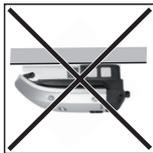
Non montare l'inverter sul soffitto.
