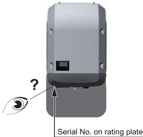
Il numero di serie dell'inverter si trova sulla targhetta sul lato inferiore dell'inverter stesso. A seconda della posizione di montaggio può risultare difficile accedere o leggere il numero di serie, ad es. se l'inverter è stato montato in un'area buia o all'ombra.
