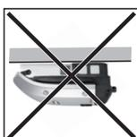
Non montare l'inverter sul soffitto.
