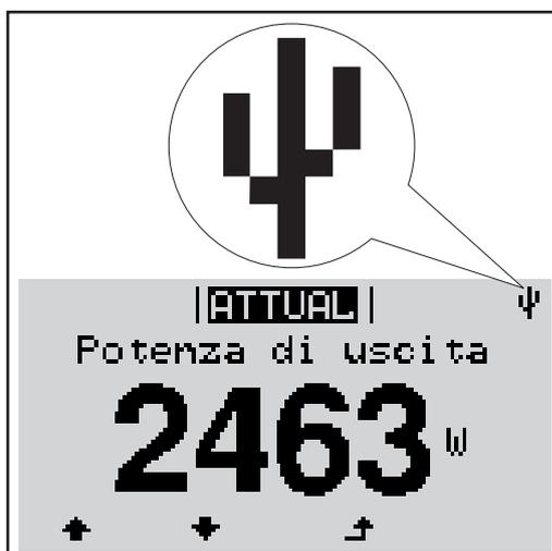
Se l'inverter riconosce una chiavetta USB, in alto a destra sul display viene visualizzata l'icona USB.
