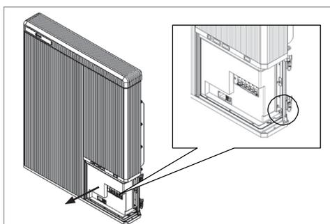
4. Spegnerne l'interruttore automatico e accertare che sia in posizione OFF. Dopodiché spegnere il sezionatore. (Dopo lo spegnimento dell'interruttore automatico, il sezionatore salta e si spegne automaticamente dopo 60 secondi.)
