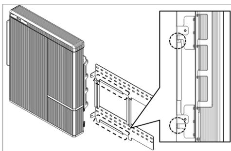
3. Montare il gruppo batterie su un fermaglio a U del supporto da parete usando il sostegno delle maniglie di sollevamento. Rimuovere le maniglie di sollevamento.
