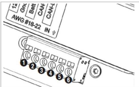
11. Per le specifiche del cavo di comunicazione, vedere la sezione 3.2.1. Per prima cosa collegare il filo di terra al terminale 2. Quindi effettuare i collegamenti agli altri terminali uno dopo l'altro, tranne il terminale 6. Lasciare il terminale 6 scollegato. Installare il coperchio di protezione prima dell'accensione.
