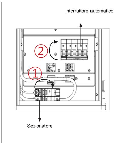
12. Collegare il gruppo batterie all'inverter. Per collegare il cavo di alimentazione e il cavo di comunicazione all'inverter, fare riferimento alle istruzioni di installazione dell'inverter. Spingere quindi il sezionatore verso alto, in modo da portarlo nella posizione di accensione (ON).
