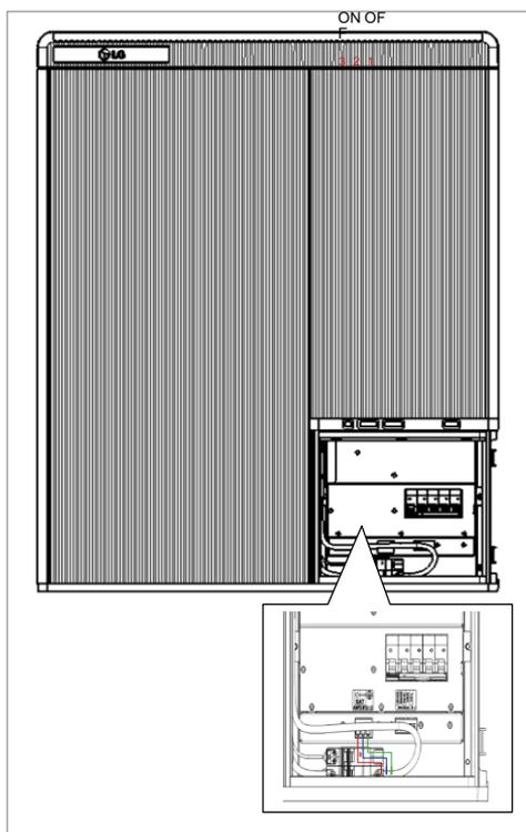
6. Verificare la tensione nel terminale del cavo di alimentazione.
