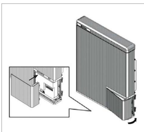
14. Rimontare il coperchio di protezione trasparente e serrare con la vite (posizione contrassegnata). Chiudere il coperchio della scatola elettrica. Rimontare la batteria sopra i due fermi sul retro.
