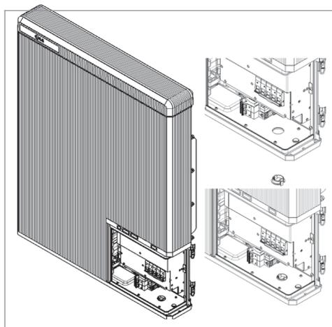
8. Rimuovere il tappo sul foro nel lato inferiore, e montare la spina della condotta da  $\frac{3}{4}$ ". In caso di installazione in ambienti esterni, deve essere sigillato per aderire alla classificazione "IP55" (p.es. con una guarnizione, schiuma sigillante, silicone, ecc.).
