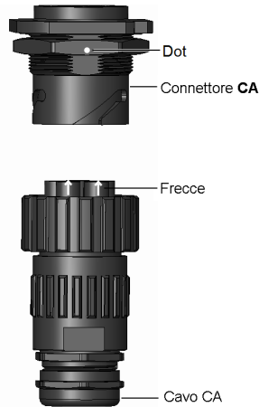
Figura 16: Collegamento del connettore CA a un'unità secondaria
