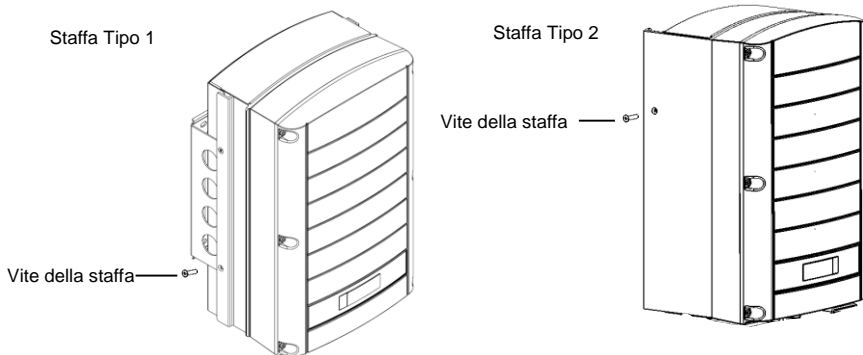
Figura 9: Inserire le viti della staffa
