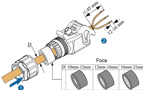
3. Inserire completamente i conduttori nei fori dei cavi corrispondenti e chiudere il morsetto.
