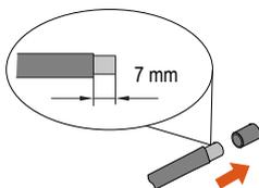
2. Montare le estremità del cavo utilizzando pinze da crimpaggio.
