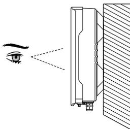
9. Installare l'inverter verticalmente per assicurare una dissipazione del calore ottimale.
