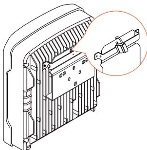
5. Rimuovere il coperchio impermeabile dal terminale RS485 e installare il modulo di comunicazione sull'inverter. La figura seguente prende come esempio il modulo Wi-Fi. Per i dettagli, fare riferimento al rispettivo manuale.
