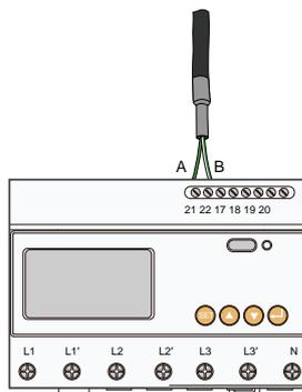
3. Spelare i cavi di alimentazione per 10 mm, quindi collegarli ai terminali del contatore di energia intelligente, come mostrato sotto. (Sezione trasversale: da 10 mm<sup>2</sup> a 25 mm<sup>2</sup>)
