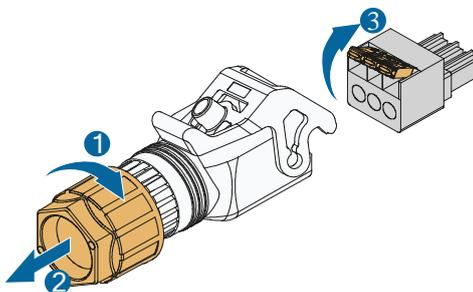
2. Condurre il cavo CA attraverso il passacavi e l'involucro. Rimuovere meno di 45 mm di guaina del cavo e spelare il filo per 12 mm–16 mm.
