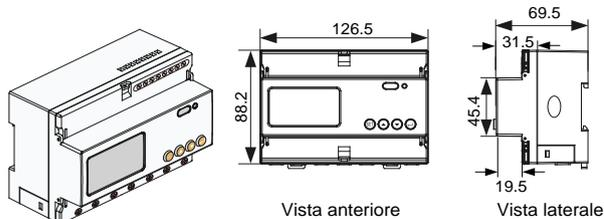
**Fig. 2-6** Dimensioni contatore trifase intelligente (unità: mm)
