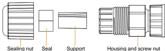
2. Dirigere il cavo di comunicazione attraverso i componenti secondo la seguente sequenza. Allineare la spina RJ45 e lo slot sulla custodia. Il cavo deve essere inserito completamente fino a quando la spina RJ45 è posizionata al suo posto.
