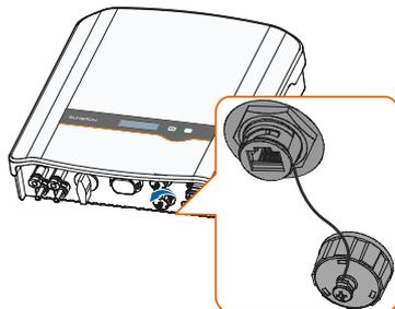
5. Allineare il connettore di comunicazione e il terminale dello **Meter**. Collegare il connettore e farli innestare perfettamente fino a quando non si sente o si sente un "clic". Fissare il dado a vite sul fondo dell'inverter.
