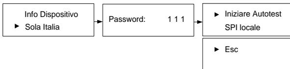
**Toccare ENT** per avviare il autotest. Se lo stato dell'inverter è “Errore” o “Spegnimento”, non è possibile avviare il test e viene visualizzato un messaggio.
