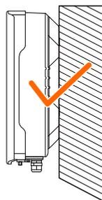
10. Non installare mai l'inverter orizzontalmente, con un'inclinazione in avanti o indietro o persino capovolto. L'installazione orizzontale può causare danni all'inverter.
