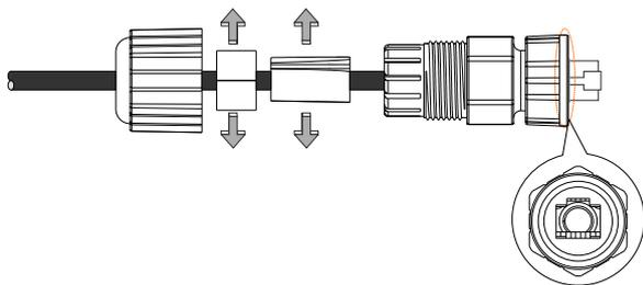
3. Spingere il supporto e la guarnizione nell'alloggiamento. Quindi serrare il dado di tenuta sull'alloggiamento.
