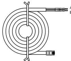
2. Collegare i connettori **A** e **B** ai terminali 21 e 22 del contatore di energia intelligente, come mostrato sotto.
