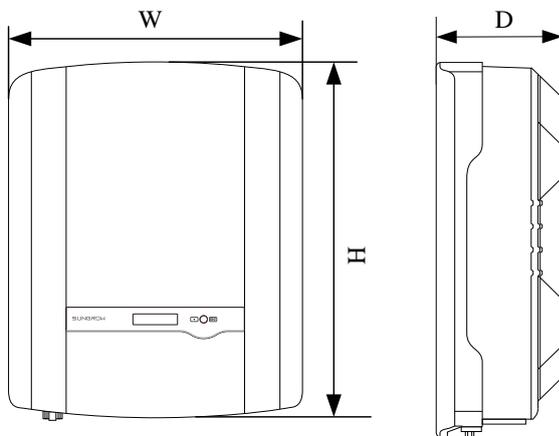
**Fig. 2-3** Dimensioni dell'inverter
