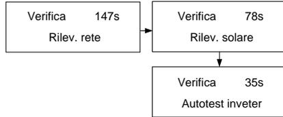
6. Se tutti i rilevamenti passano e la luce solare è sufficiente, l'inverter entra nello stato di funzionamento.
