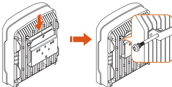
4. Per proteggere l'inverter dai furti, è possibile bloccarlo con un lucchetto. Se necessario, il lucchetto deve essere acquistato dall'utente. Il diametro del foro è circa 8 mm.
