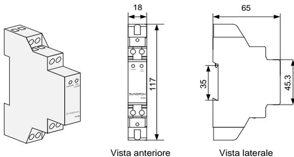
**Fig. 2-5** Dimensioni contatore monofase intelligente (unità: mm)
