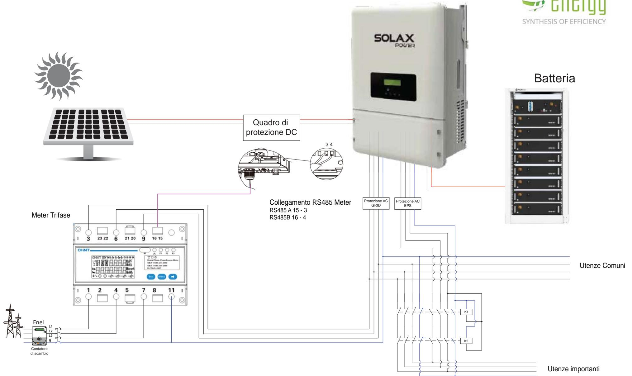
Dimensionare K1 e K2 in funzione del valore del carico delle utenze comuni.
